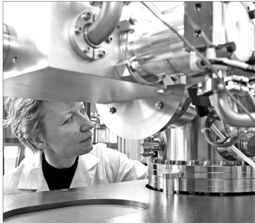
Dr hab. inż. Jolanta Baranowska na stanowisku do wytwarzania powłok metodą PVD w Technologicznym Laboratorium Inżynierii Powierzchni.
